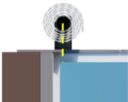
Le centre de l'axe d'enroulement doit être à l'aplomb de la margelle.
