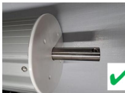
Introduzca el husillo en el eje de bobinado hasta el tope (con el lado perforado hacia fuera del eje de bobinado).
